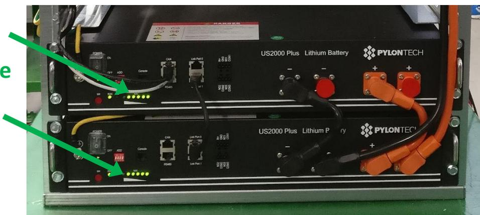
Figura 10 - Verificare accensione led moduli batteria
