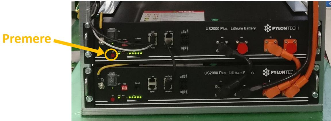
Figura 43 - Premere il pulsante rosso "SW" della batteria più in alto
